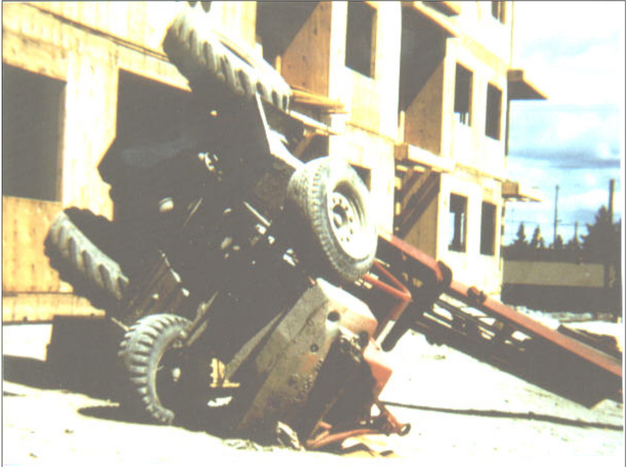
Este montacargas se volcó porque el Centro de Gravedad salió afuera del Triángulo de Estabilidad
